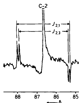
Fig. 1. Ausschnitt aus dem eindimensionalen ^{13}\text{C} -INADEQUATE-NMR-Spektrum von 1 bei 25 MHz (JEOL FX-100). Meßlösung: 2.5 mL 1 , 0.3 mL \text{CDCl}_3 und ca. 10 mg \text{Cr}(\text{acac})_3 (als Relaxationsreagens). Pulsfolge: 90^\circ (x)- \tau - 180^\circ ( \pm y)- \tau - 90^\circ (x)- \Delta - 90^\circ ( \phi )-Datenaufnahme; \tau eingestellt für J_{\text{CC}}=65 Hz. 12704 Durchgänge, Wiederholungsintervall 5 s (Gesamtmesszeit 16 h).
